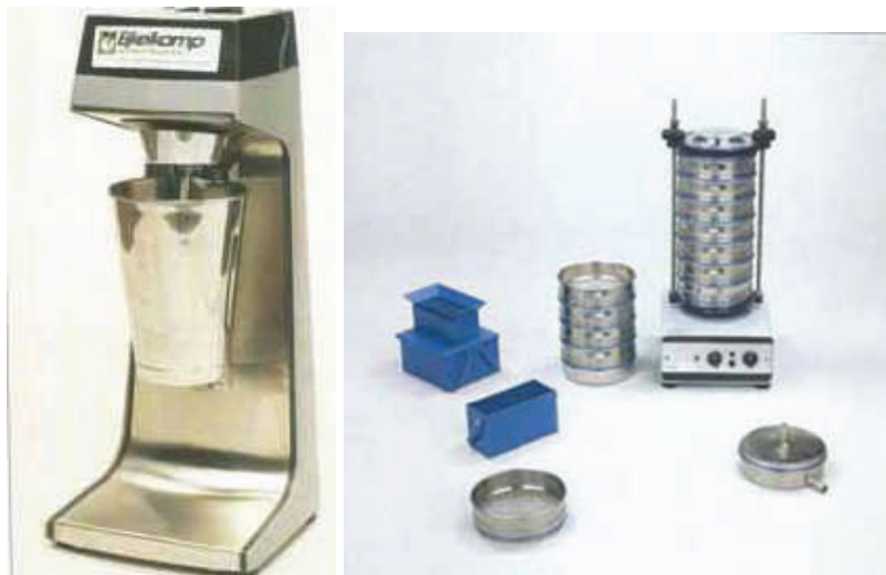
Мелница за мелење на почва и сита за сеење на почва
